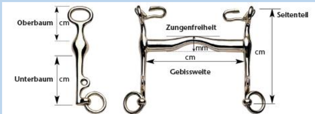
Abbildung 3: Länge der Seitenteile bei Kandaren
